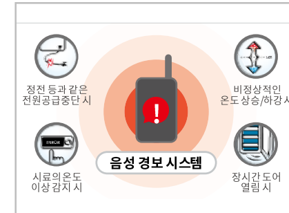
이상 발생이 등록된 7대의 전화에 알람을 보내 신속한 대처로 백신 피해 최소화 (70, 650, 1400 모델)
